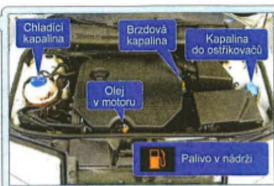
Správná výška hladiny jednotlivých provozních kapalin je obvykle vymezena ryskami min. a max. Pohybují-li se hladiny kapalin pod ryskou min., je nutné přistušnou kapalinu doplnit.
